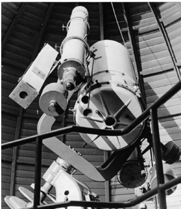
Přístrojové vybavení v kopuli kolem roku 1970. Sluneční fotokomora, 200mm refraktor, „velká“ a „malá“ Schmidtova fotokomora (zleva).
