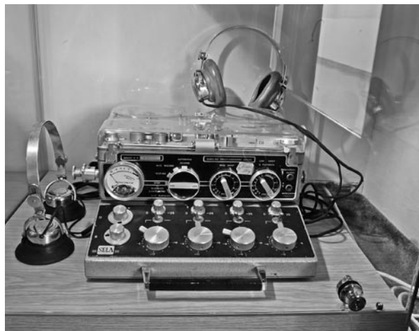
Tuto reportážní sestavu tvořil magnetofon NAGRA III, mixážní pultík SELA a sluchátka značky Brown. Tato rozhlasová technika se používala v 60. až 80. letech a umožňovala mixáž až pěti mikrofonů.
