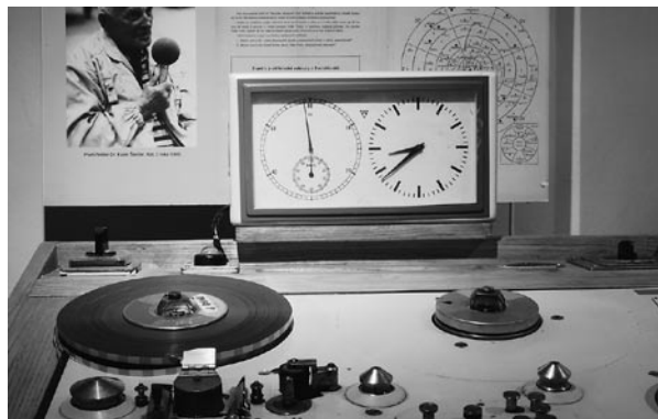
Stříhový magnetofon K5 (výrobce: Sandler and Jansen Berlin, Německo) sloužil v Českém rozhlasu Olomouc již od roku 1958 ke zvukové montáži a k mechanickému stříhu magnetofonových pástů.
