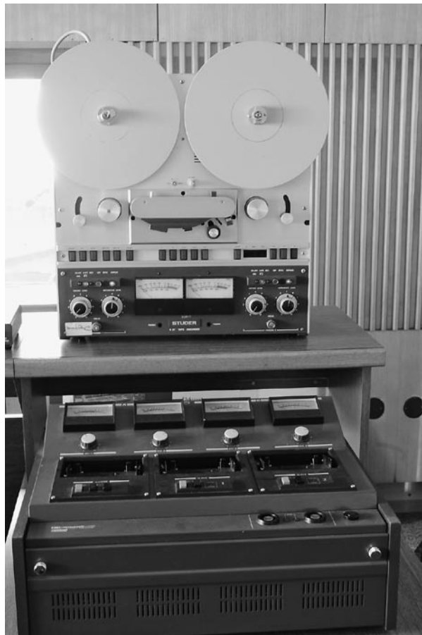
Magnetofon Studer B 67 (výrobce: Willi Studer, Švýcarsko) se používal od druhé poloviny 70. let do konce analogové éry.
