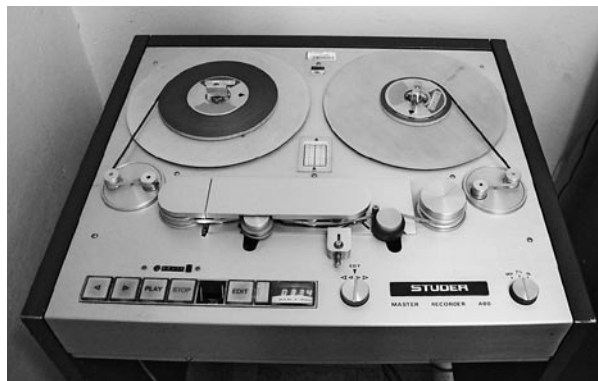
Magnetofon Studer A 80 (výrobce Willi Studer, Švýcarsko). Tento dvoustupý studiový magnetofon patřil k základnímu přístrojovému vybavení hudební režie. V Československém rozhlasu se používal od roku 1975.
