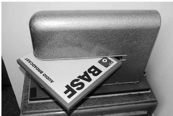
Elektronická mazačka pásků: nenápadný a trochu tajemný přístroj v sobě skrýval silný elektromagnet, který v případě potřeby během několika okamžiků dokázal smazat celou cívku magnetofonového pásku. Cívka se vkládala do prostoru s elektromagnetickým polem zásadně i s kartonovou krabicí.
