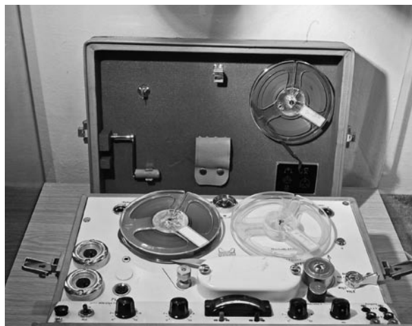
Český rozhlas Olomouc používal v druhé polovině 50. let také tento cívkový magnetofon značky MAIHAK, na kterém vidíte mikrofonní a linkové vstupy, manuální regulaci a linkový výstup. Posun pásků se prováděl čistě mechanický – vpřed, a to natažením péra přiloženou klíčkou, a vzad otáčením klíčkou.
