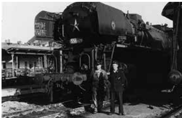
V 50. letech posílilo přerovskou výtopnu skoro 70 těžkých lokomotiv pro nákladní dopravu řady 556.0; stroje byly vybaveny mechanickým příkladačem uhlí „Standard Stocker“, takže se jim přezdívalo Štokr. Foto: Jaroslav Kryl a Dušan Šimek.
